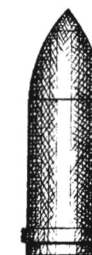
Бронзовый 3-хъ дюйм. фугасный (сухого пироксилина) снарядъ для полевой скорострѣльной пушки по проекту капитана Гобято и подпор. Никольскаго.
