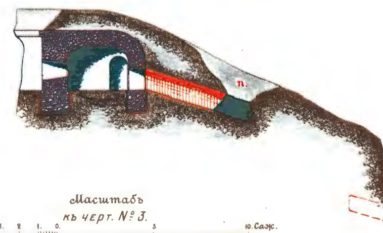
Чертежъ № 4 Профиль капонира по линіи № 1. къ чер. № 3
