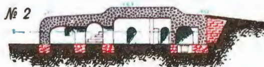
Батарея № 13 на Золотой горѣ для 6 одиннадцати-дюймовыхъ мортиръ и 2-57 м скорострѣльныхъ пушекъ.
