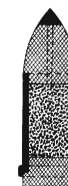
Бомба (Головная часть мины) приспособленная для стрѣльбы изъ 47 м/м. пушки по проекту Мичмана ВЛАСЬЕВА.
