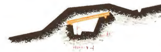
Чертежъ № 4 Профиль блиндажа въ окопѣ на мѣсть форта № VI къ чер. № 2
