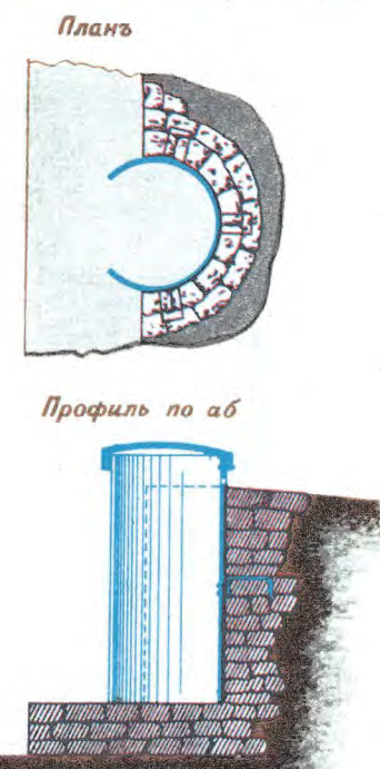
ПРОФИЛИ ОКОПОВЪ СЪ КОЗЫРЬНОМЪ И ПРИКРЫТИЕМЪ ОТЪ ПУЛЬ И ОСКОЛКОВЪ
